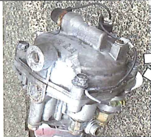
リレー・エマージェンシ・バルブの例 (リレー・バルブ、ヒータ付)
